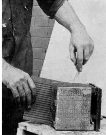
Fig. 225. Inserting Separators
