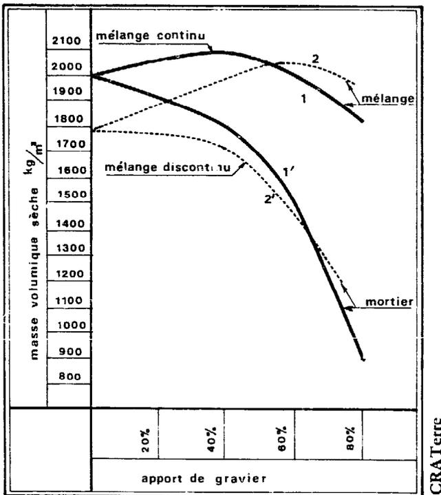
nant de 20 à 30 % d'éléments grossiers. Cette composition conduit à un gain appréciable de compacité du mélange compacté tout en garantissant une bonne compacité du mortier.
