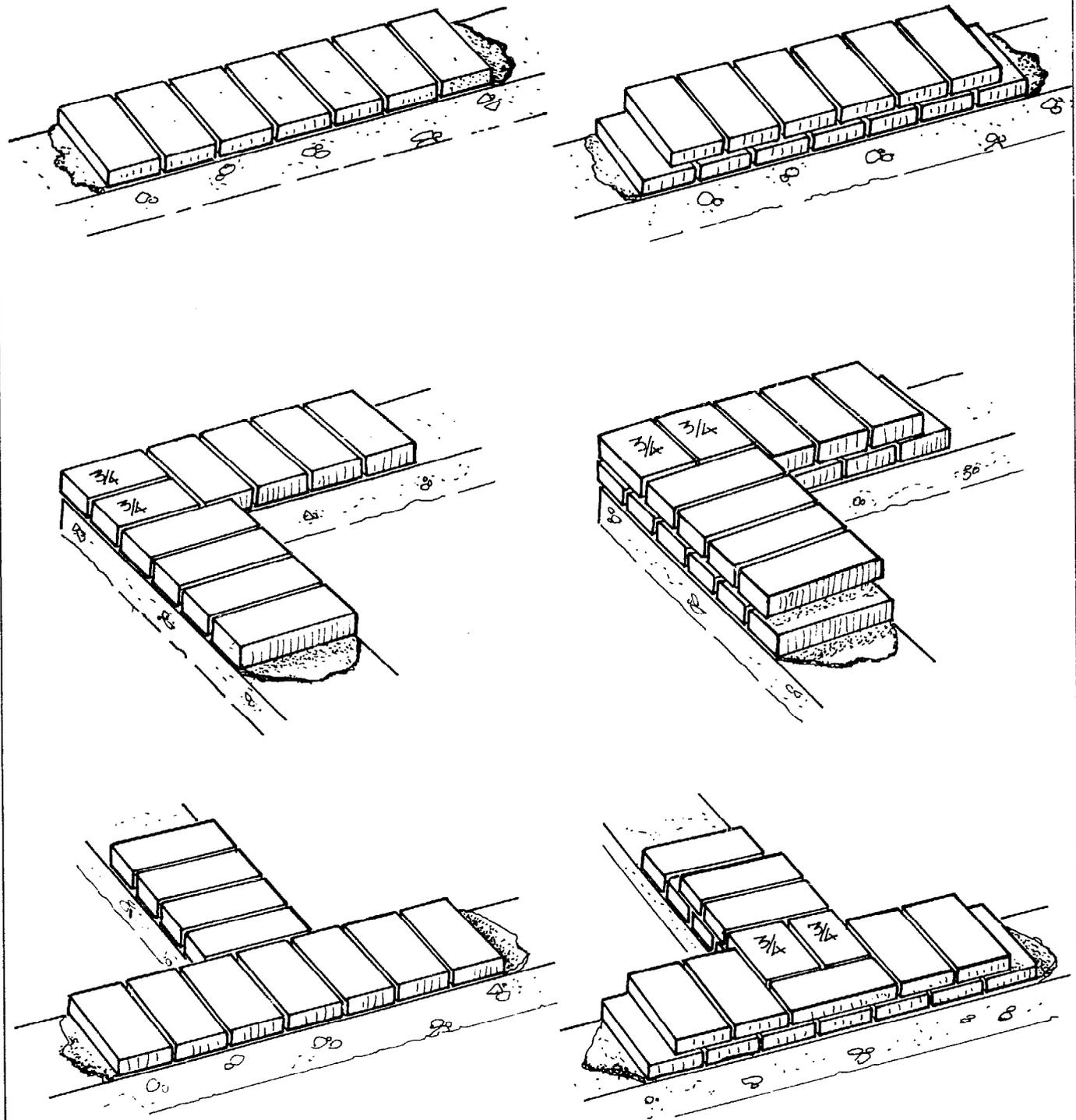
FIGURE 181 : APPAREILLAGES
