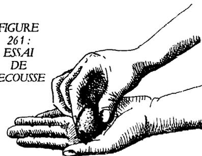
**b) réaction lente :** il faut entre 20 et 30 coups pour que l'eau apparaisse à la surface. Ensuite, lorsque l'on presse, l'échantillon ne se craquèle ni ne s'effrite, mais il s'aplatit comme une boule de mastic.
