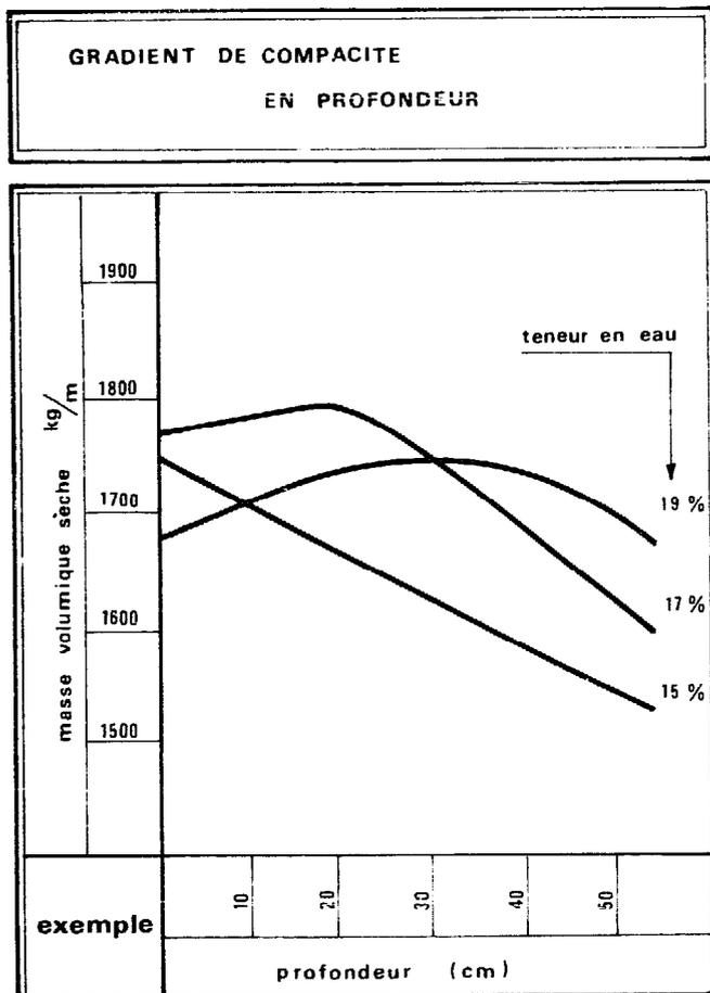
1) Si la teneur en eau est inférieure à la teneur optimum, la densité sèche décroît presque linéairement avec la profondeur.
