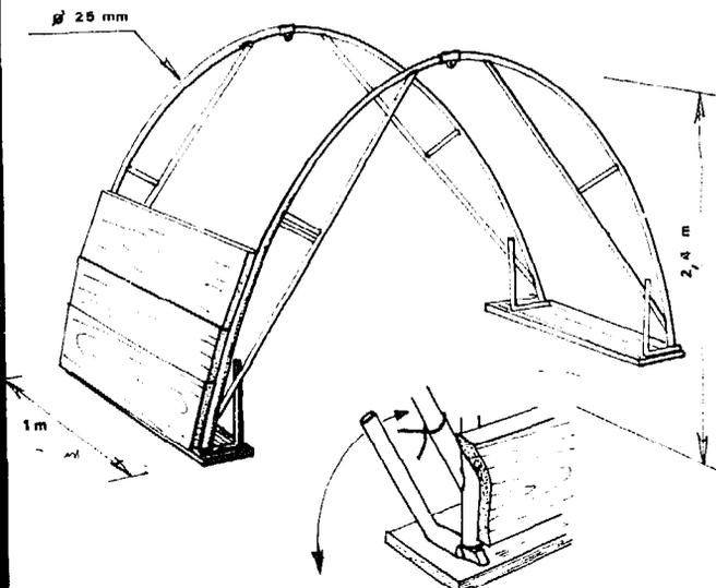
FIGURE 306 : COFFRAGE EXPERIMENTAL AVEC CAME FACILITANT LE DECOFFRAGE
