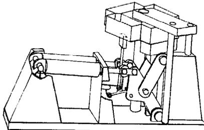
Presse hydraulique à plateau tournant avec remplissage, compression et démoulage synchronisés. Dimension: (L x L x H) 56 x 113 x 56. Pression en Kg F/cm<sup>2</sup>: 24. Dimension des briques: 30 x 22 x 15 cm. Production: 2.000 jour. Prototype de la faculté d'Architecture UST KUMASI.
