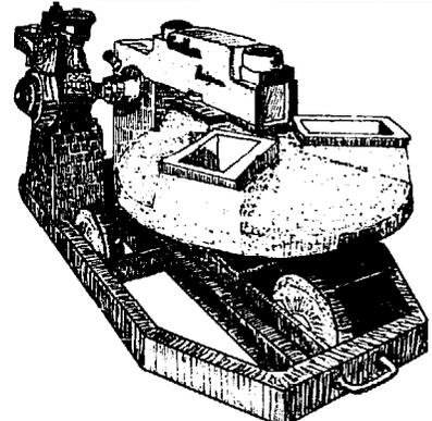
Presse hydraulique à plateau tournant avec remplissage, compression et démoulage synchronisés. Poids net: 1800 Kg. Moteur à Essence - Pression en Kg F/cm<sup>2</sup>: 75. Dimension des briques: 30 x 15 x 10 cm. Nombre de briques par jour: 1.120. Matériel: Guilhon Barthelemy 18 R<sup>e</sup> de Montfavet, 84. Angnon. Le même type que la presse Winget. Un seul exemplaire construit.
