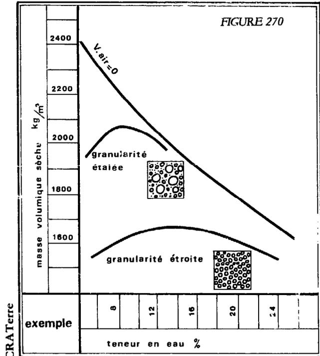
nularités étalées, caractéristiques de matériaux dont les grains ont des grosseurs variées, donnent par contre, des courbes de compactage à maximum accentué : la compacité obtenue est meilleure. Un mélange d'éléments fins et grossiers devrait donc permettre l'obtention de produits compactés plus denses que ceux obtenus avec des sols exclusivement composés d'éléments fins. C'est bien ce que l'on constate par exemple lorsqu'on ajoute des graviers à du mortier (fig. 271).
