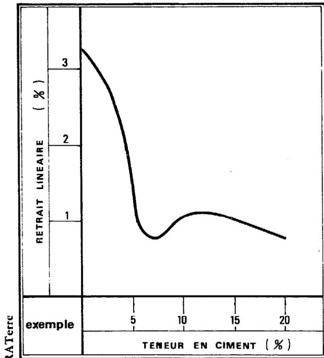
ment supérieure n'apporte en général pas de diminution supplémentaire du retrait. De même, les terres stabilisées au ciment acquièrent une bonne résistance à l'action des variations cycliques de teneur en eau (alternance : séchage-mouillage) et des cycles de gel-dégel.
