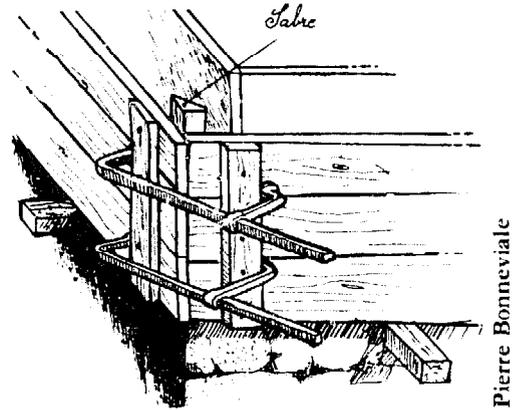
FIGURE 28 : CHAINFREINAGE DE L'ANGLE PAR POSE D'UN « SABRE » DANS L'ANGLE EXTERIEUR DE LA BANCHE
