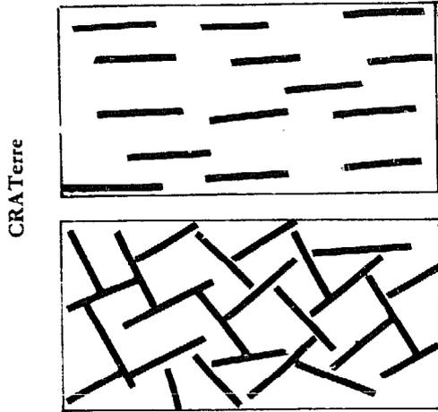
Dans ces conditions, les effets du compactage diffèrent sensiblement selon la structure : l'état floculé correspond généralement aux faibles teneurs en eau, cependant que l'état dispersé est caractéristique des teneurs en eau élevées. En particulier, le long d'une courbe de compactage, la structure sera plutôt dispersée à droite de l'optimum et plutôt floculée à gauche (fig. 275). En A, les particules se rapprochent et
