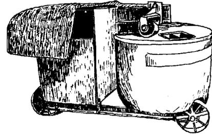
Presse mécanique à plateau tournant avec remplissage, compression et éjection synchronisés. Dimension: (L x L x H) 66 x 200 x 120 cm. Poids net: 1500 Kg. Moteur: Essence 3cv 14/h - Diesel: 5,5 cv 15 l/h. Taux de compression: 1,6. Briques: 30 x 23,5 x 8 cm. Production par jour: 4000 - Profondeur maxi du moule: 128 mm - Course maxi du plateau: 48 mm - Nombre d'ouvriers: 3. Matériel Villers Perwin. Similaire à la presse HALLUMECA.
