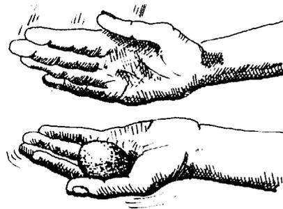
FIGURE 261 : ESSAI DE SECOUSSE
