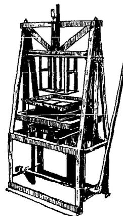
Pilonneuse à bras avec ressorts de rappel. Main d'œuvre 1 ou 2 ouvriers. Poids de la presse équipée d'un ou deux moules et pilon, en caisse 345 Kg.
