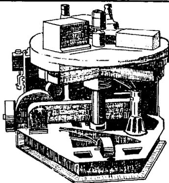
Presse hydraulique à plateau tournant avec remplissage, compression et démoulage synchronisés. Poids net: 1800 Kg. Moteur à essence - Pression en Kg F/cm<sup>2</sup>: 75. Dimension des briques: 30 x 15 x 10 cm - Nombre de briques par jour: 1.120. Matériel: Winget works - Rochester - ME 2.44A - G.B.
