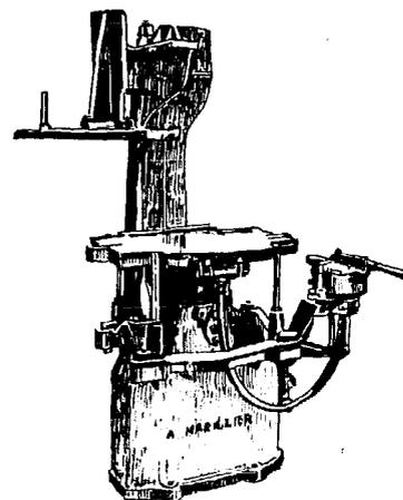
Ce genre de machines, utilisé pour la fabrication de moule de fonderie, doit convenir pour le compactage de la terre, si l'on dispose d'un compresseur. La table fait corps avec un piston de 16 cm de diamètre, actionné à l'air comprimé à 6-7 kg. A l'intérieur du piston, une masse mobile peut compléter l'action de ce dernier en frappant le dessous de la table à une cadence atteignant 800 coups minutes. En haut, le contre-plateau est fixe dans le sens vertical et éclipse latéralement.
