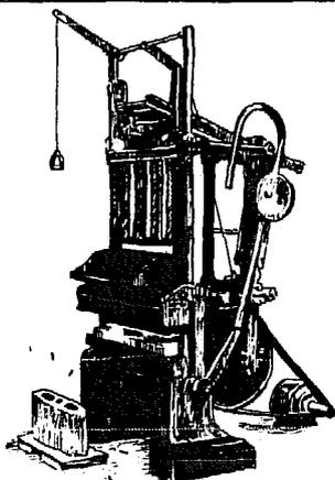
Pilonneuse à moteur. La frappe est basée sur le principe du petit marteau pilon (cour-roie de friction et volant d'inertie).
