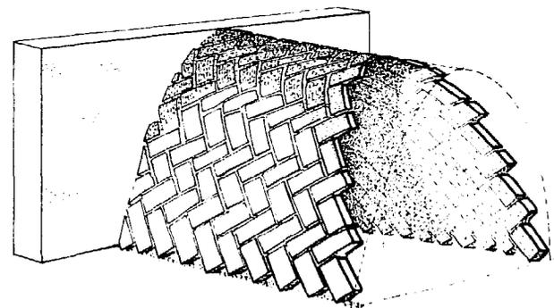
FIGURE 307 : APPAREILLAGE EN EPIS (OU EN CHEVIRON)
