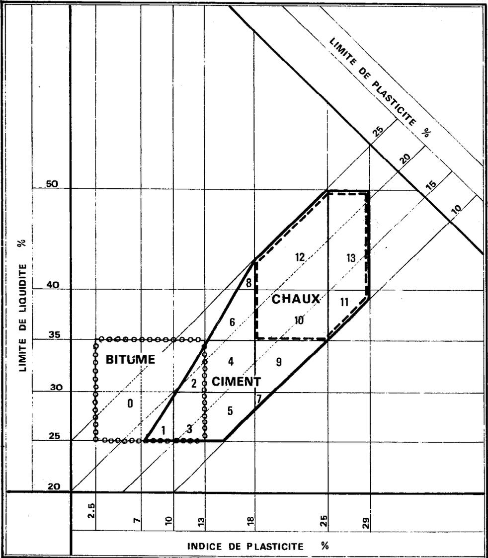
FIGURE 282 : STABILISANTS ET LIMITES D'ATTERBERG
