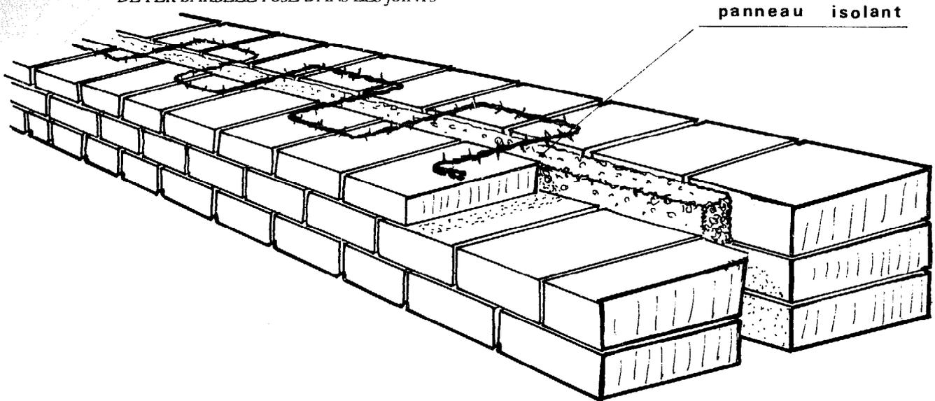
ment au mortier et qu'ils sont protégés contre la corrosion ou le pourrissement.
