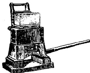
Le mélange est tassé par pilonnage à l'aide d'un couvercle lourd qui évite ainsi une partie du pilonnage à la pilette. Démoulage par fond de moule montant. Permet la fabrication d'un parpaing à la P.S.
