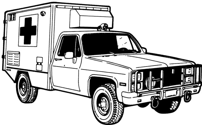
*Figure 10-9. Truck, ambulance, 1<sup>1</sup>/<sub>4</sub> ton, 4x4, M1010.*
