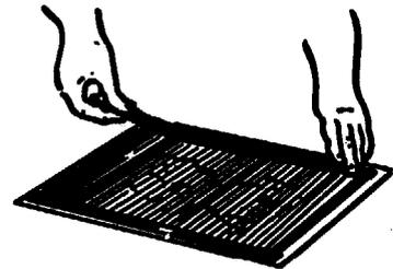
NOW TURN POSITIVE OVER SO THAT THE ATTACHED TISSUE IS ON THE UNDERNEATH SIDE AND PROCEED TO SAFE-EDGE WITH BLACK TAPE OVERLAPPING EDGE OF TISSUE 1/2 IN.
