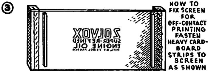
③ NOW TO FIX SCREEN FOR OFF-CONTACT PRINTING FASTEN HEAVY CARD-BOARD STRIPS TO SCREEN AS SHOWN
