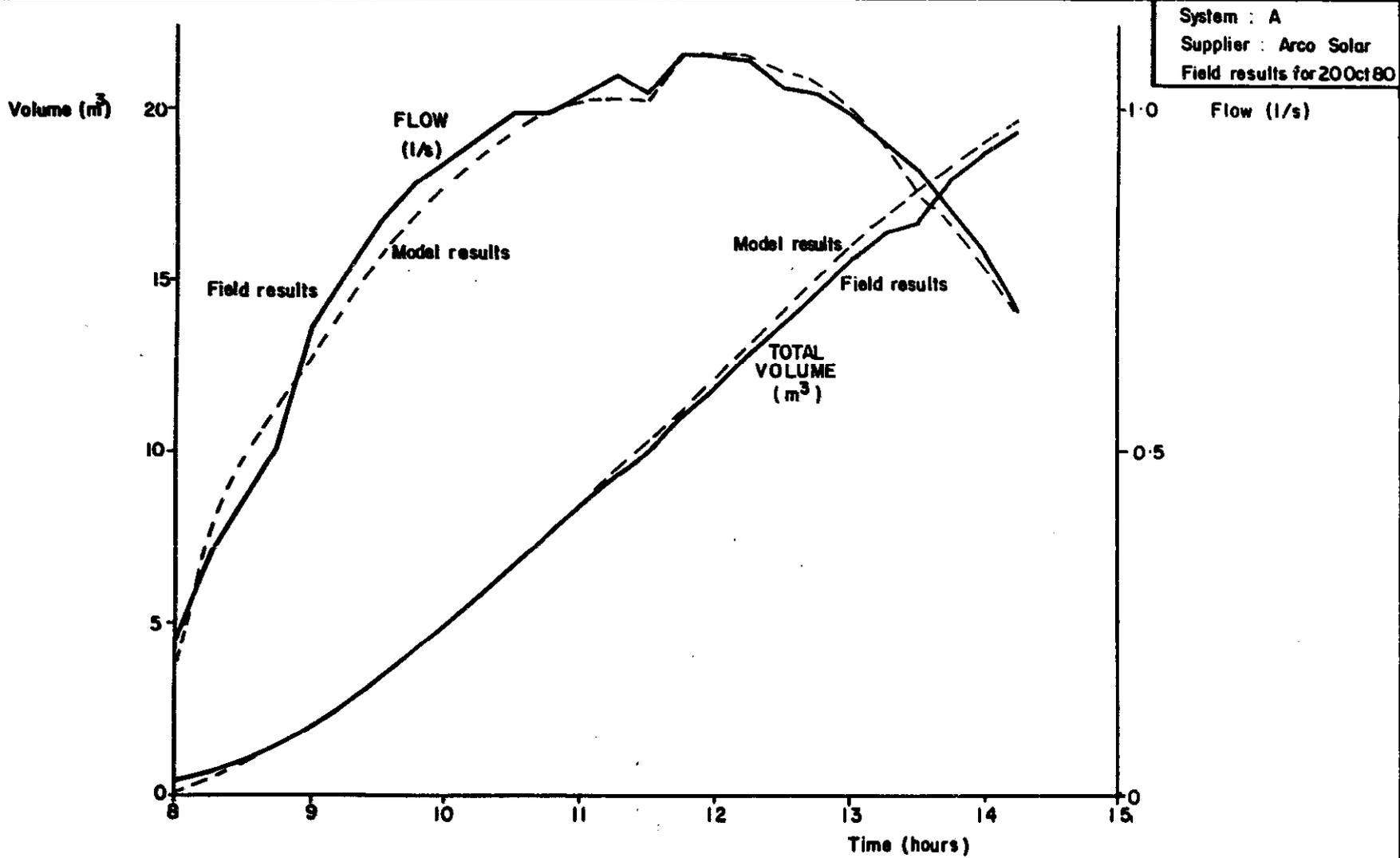
FIGURE 36 - VALIDATION OF PHOTOVOLTAIC SYSTEM MODEL (PUMP OUTPUT)
