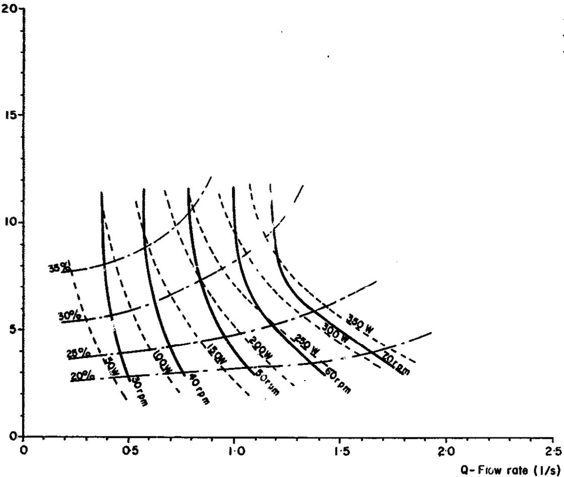
FIGURE 29 - FRIESS PUMP AGM PUMP PERFORMANCE
