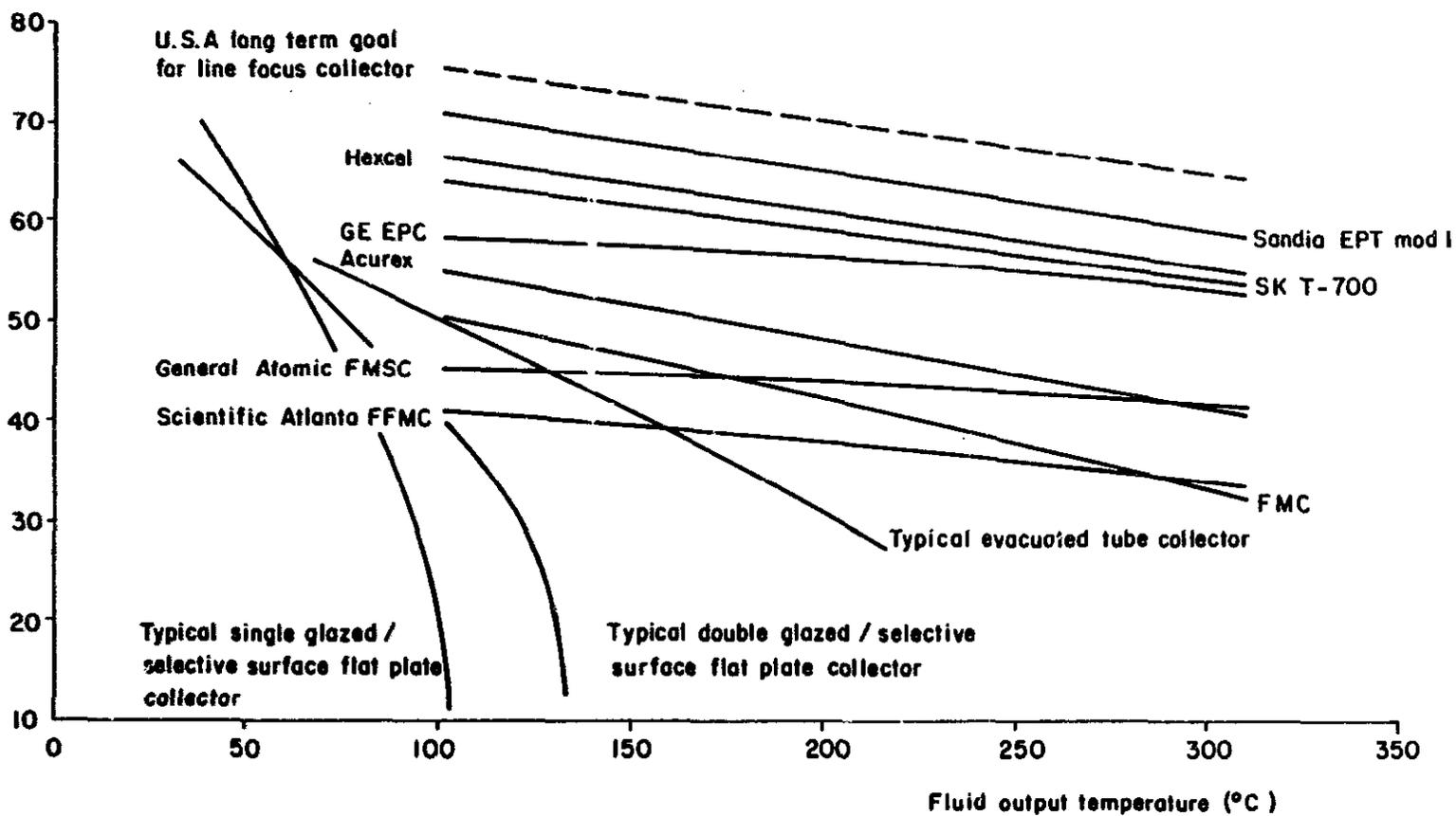
FIGURE 43 - COMPARISON OF SOLAR COLLECTOR PERFORMANCES
