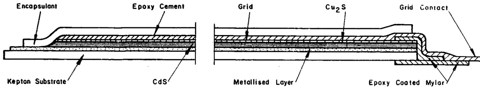
FIGURE 19 - CADMIUM SULPHIDE SOLAR CELL
