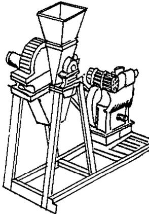
**BOTTOM DISCHARGE HAMMER MILL**
