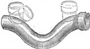
Fig. 159.—Ventilating Syphon.
