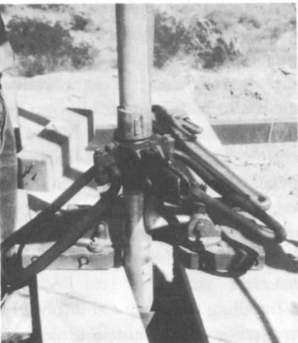
*Figure 5.2. A pipe clevis.*
